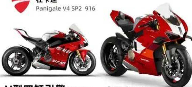
V型四缸引擎 1103cc 215.5匹马力
